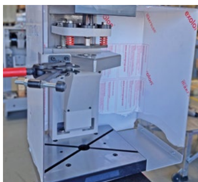
▶ 7T HYDRO z narzędziem do wykonywania otworów \varnothing w detalach z tworzywa
