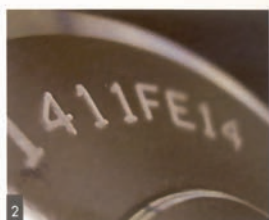
Znakowanie numerów seryjnych na elementach stalowych
